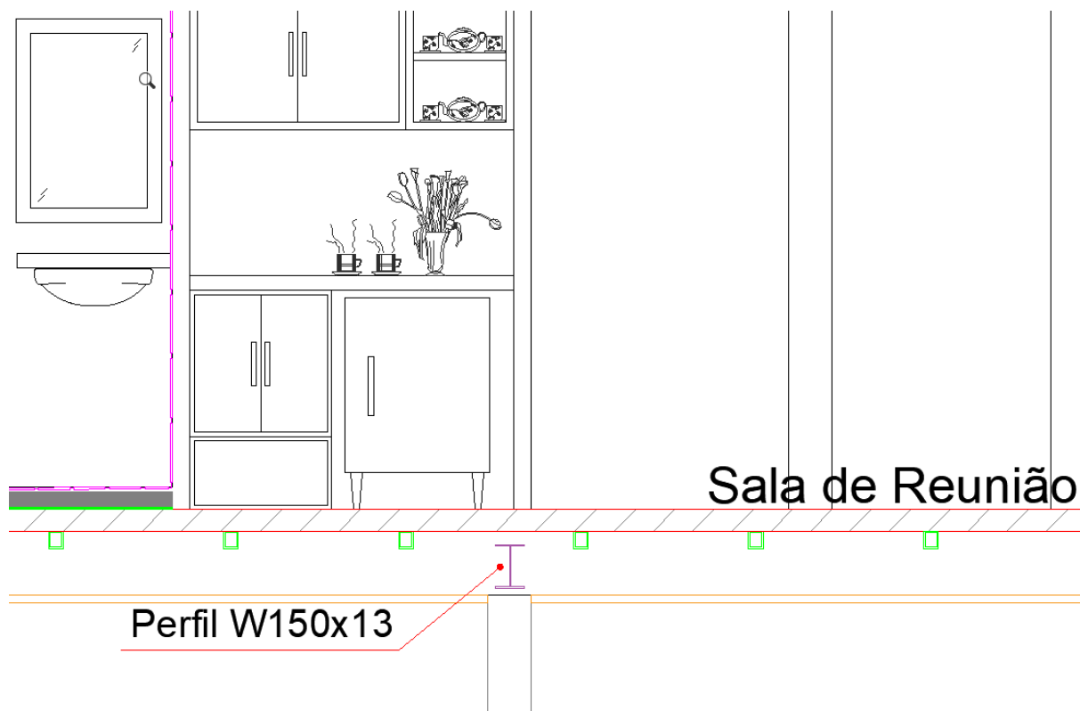
Figura 4.4 – Posição em Corte do perfil laminado metálico W150x13, embutido nas paredes de tijolos maciços (10 cm de cada lado) para adequação da Sala de Reuniões para Alojamento no Gabinete do Secretário. Segundo Projeta da Arquiteta Andresa Barbosa Carmo, de abril de 2019
