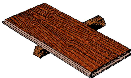
Posicionamento das régua de madeira sobre os barrotes.
