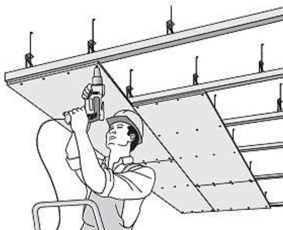
Forro estruturado com canaleta ômega
